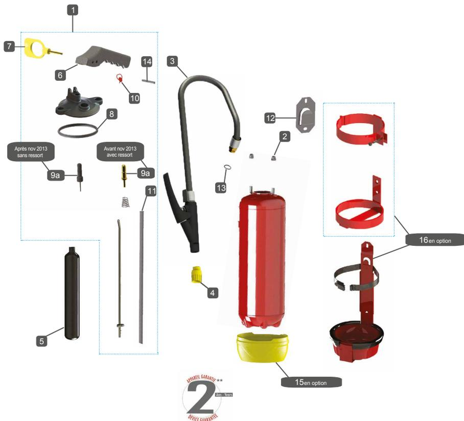
\*Cet extincteur est conçu pour être suspendu avec le support mural. S'il venait à être posé sur le sol, il doit être obligatoirement muni du socle approprié.
